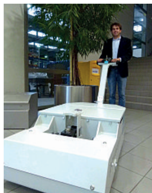
Der «powercat» nimmt bis zu 16 t schwere Boote «an den Haken».
